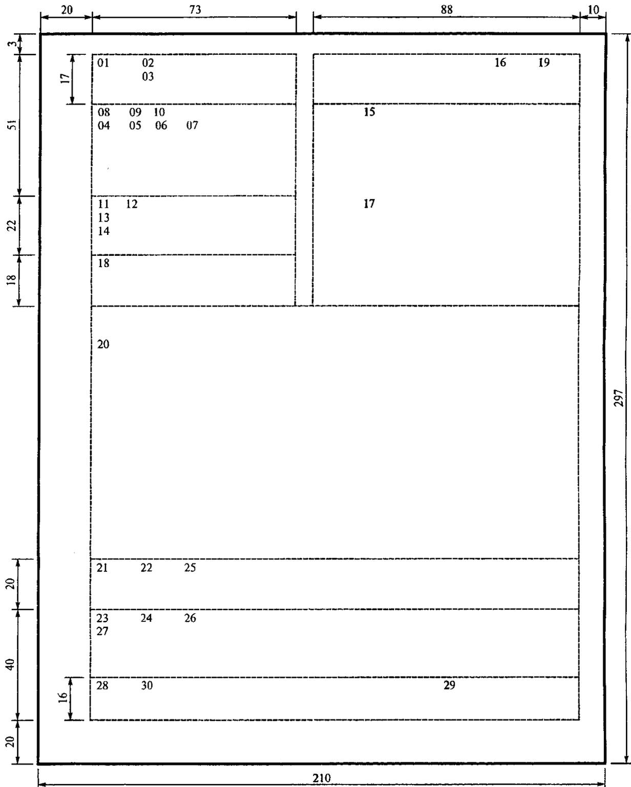
Рисунок А.1 – Схема расположения реквизитов и границ зон на формате А4 углового бланка
