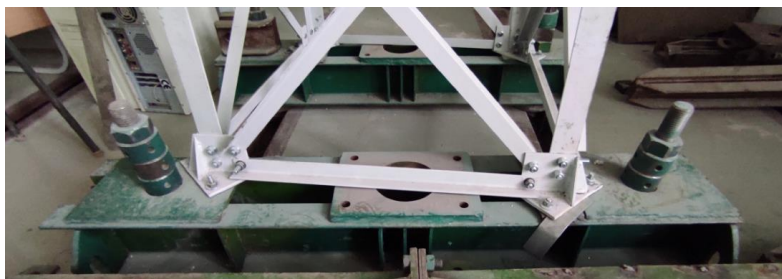
Рисунок 1 – Платформа экспериментальной опоры ЛЭП
