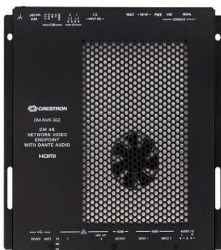
Рисунок 2 - DM-NVX-352 и подписи интерфейсов устройства.
