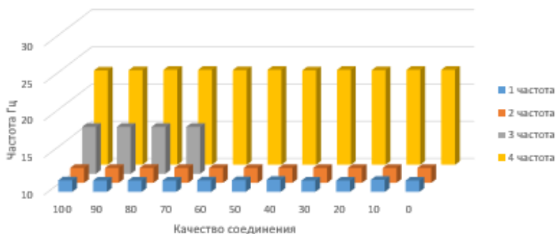
Рисунок 1 – Изменение частот при ослаблении соединения №1
