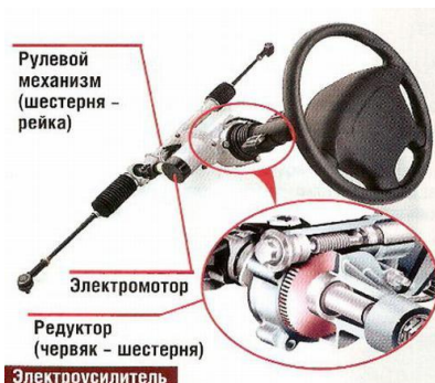
Рисунок 1 - Схема рулевого управления редукторного ЭМУР колонного типа
