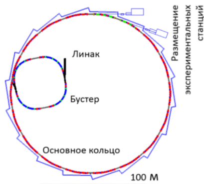
Рисунок 1 – Схема ускорительно накопительного комплекса
