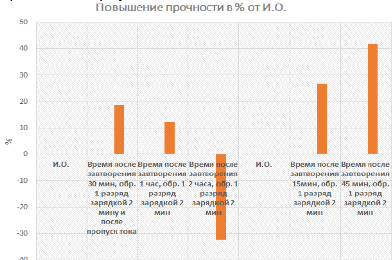
Рисунок 2 – Гистограмма повышения прочности в зависимости от времени обработки, прошедшего после затворения цемента водой
