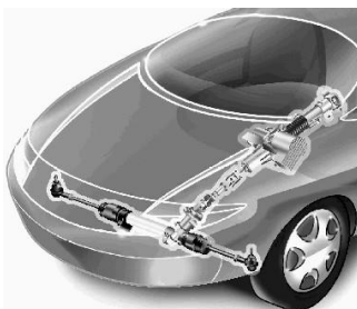
Рисунок 1 – Расположение ЭМУР колоночного типа в автомобиле.
