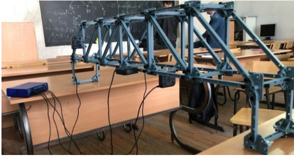
Рисунок 3 - Отдельно стоящий мост Хова, построенный с помощью набора сборки ферменных конструкций PASCO
