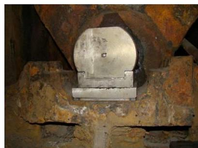
Рис. 6. Подкладки под оси рам после ремонта
