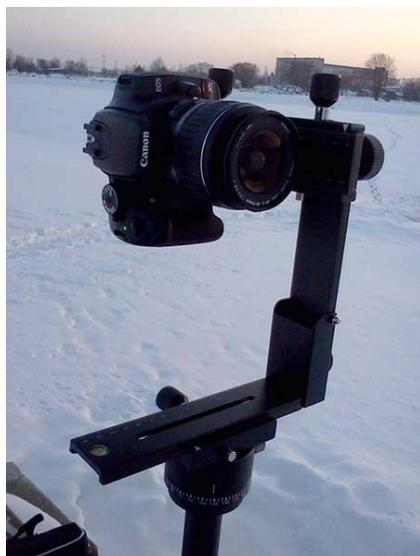
Рис. 1. Специализированная панорамная штативная головка с установленным фотоаппаратом
