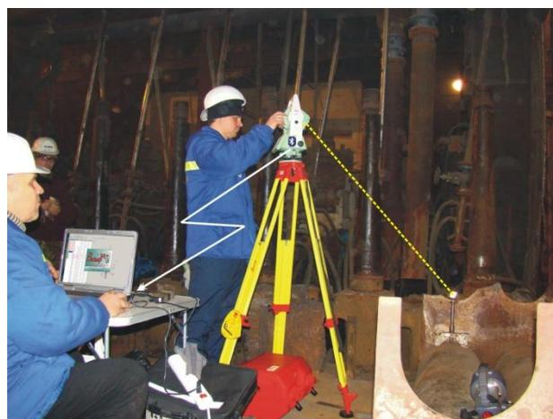
Рис. 2. Измерительный комплекс «Визир 3D»
