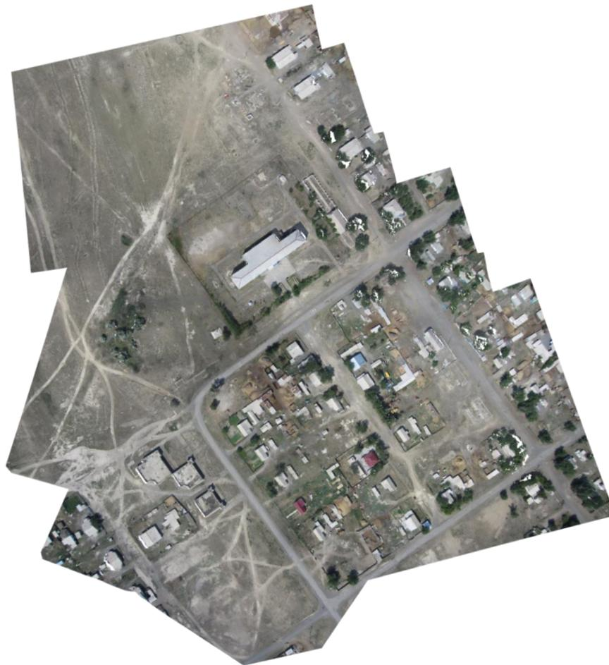
Рис. 5. Пример ортофотомозаики населенного пункта, созданной по снимкам с БПЛА Swinglet
