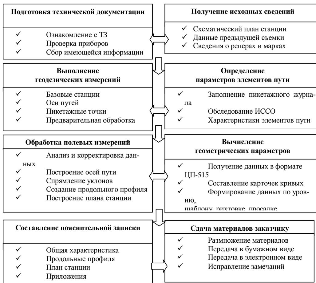
Рис. 3. Технологическая схема для съемки железнодорожных станций
