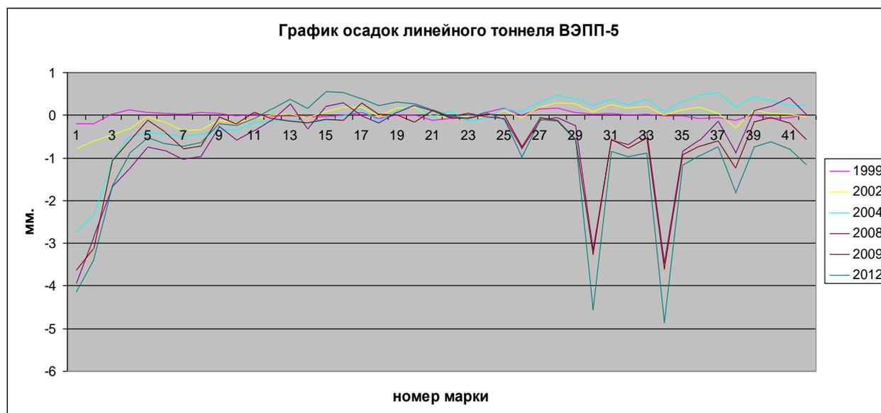
Рис. 3. График осадок линейного тоннеля ВЭПП-5
