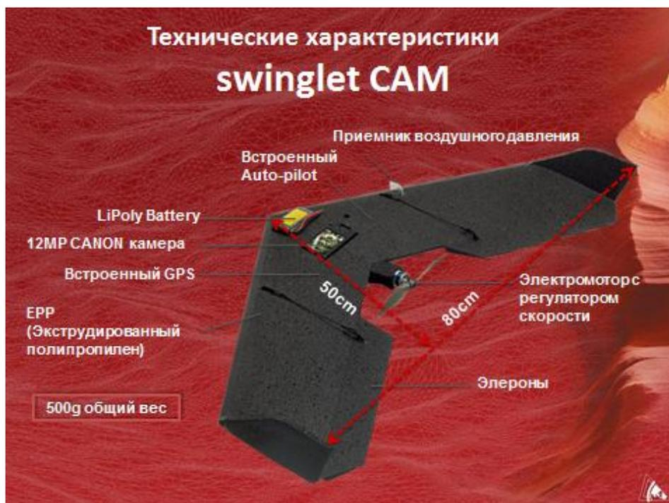
Рис. 2. Технические характеристики Swinglet CAM
