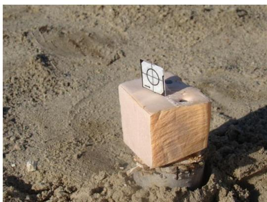
Рис. 3. Отражательная пластина на кольешке ( $k3$ ,  $k4$ )
