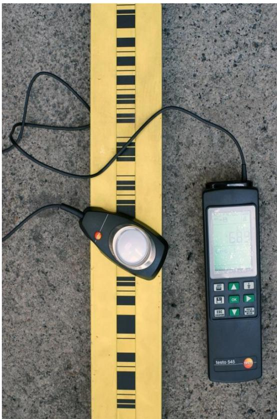
Рис. 2. Цифровой люксметр testo 545 и инварная кодовая рейка
