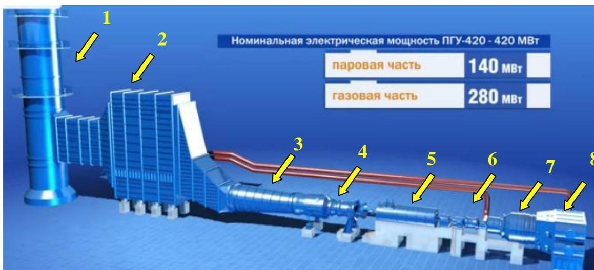
Рис. 1. Схема ПГУ мощностью 420 МВт:
