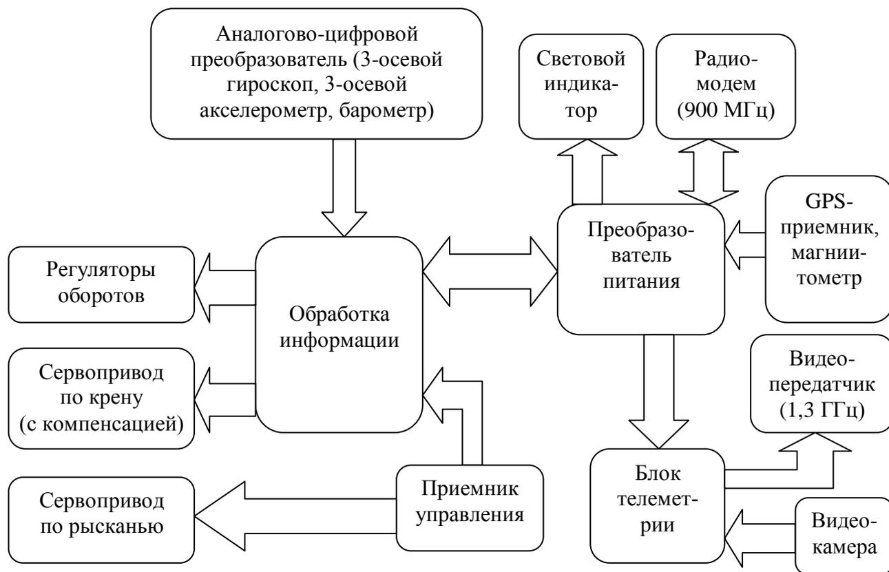
Рис. 2. Блок-схема сигнальных соединений БПЛА «Дредноут»
