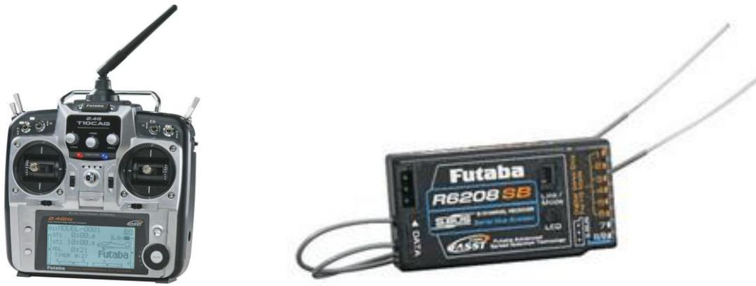
Рис. 3. Приемно-передающее устройство управления
