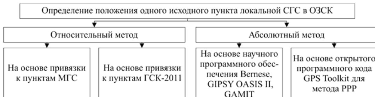
Рис. 1. Способы определения координат наземного пункта в ОЗСК
