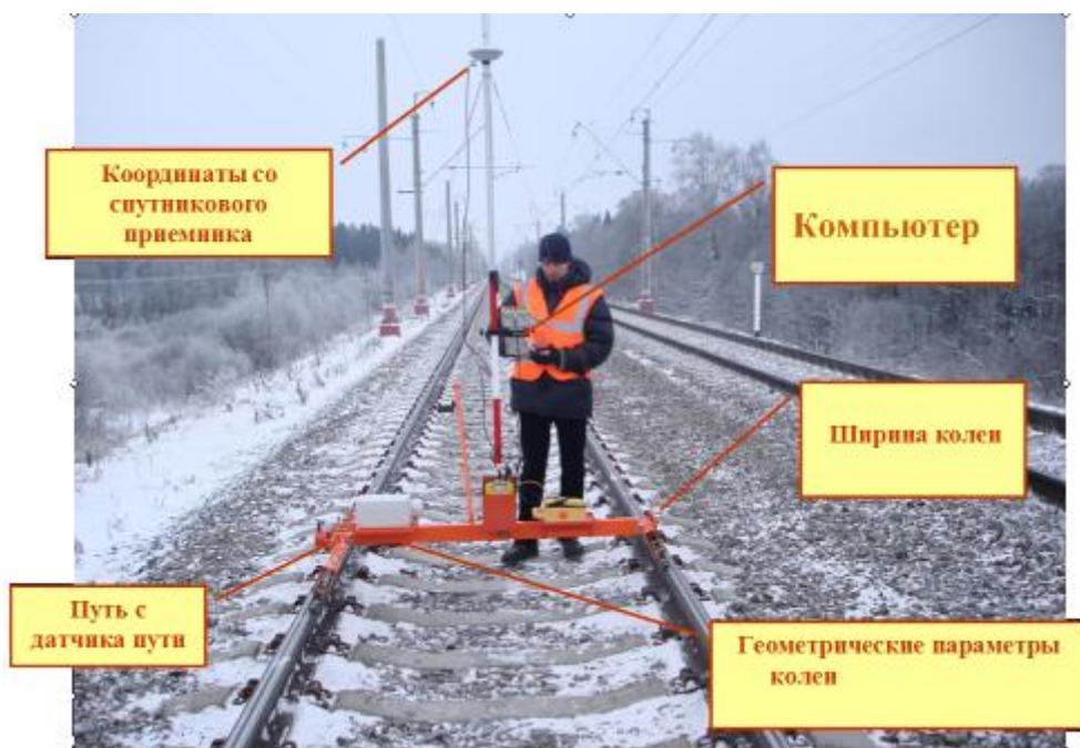
Рис. 2. АПК «Профиль»
