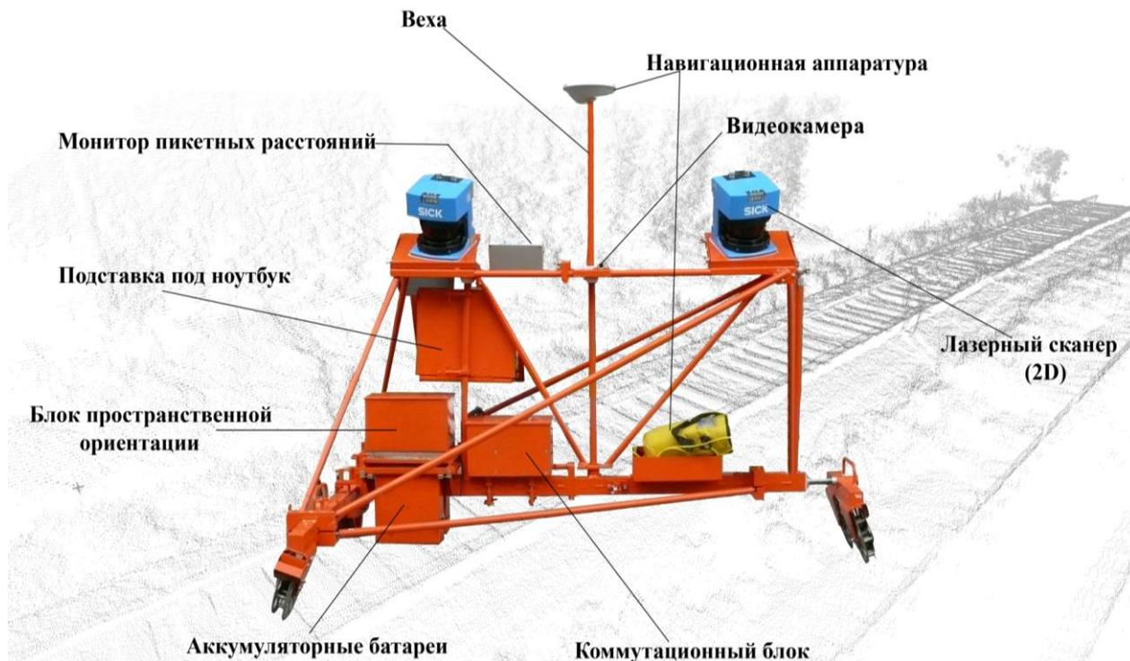
Рис. 1. Устройство АПК «Сканпуть»
