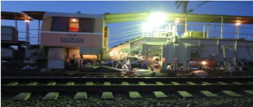
Рис. 3. Внешний вид электробалластера ЭЛБ -4С
