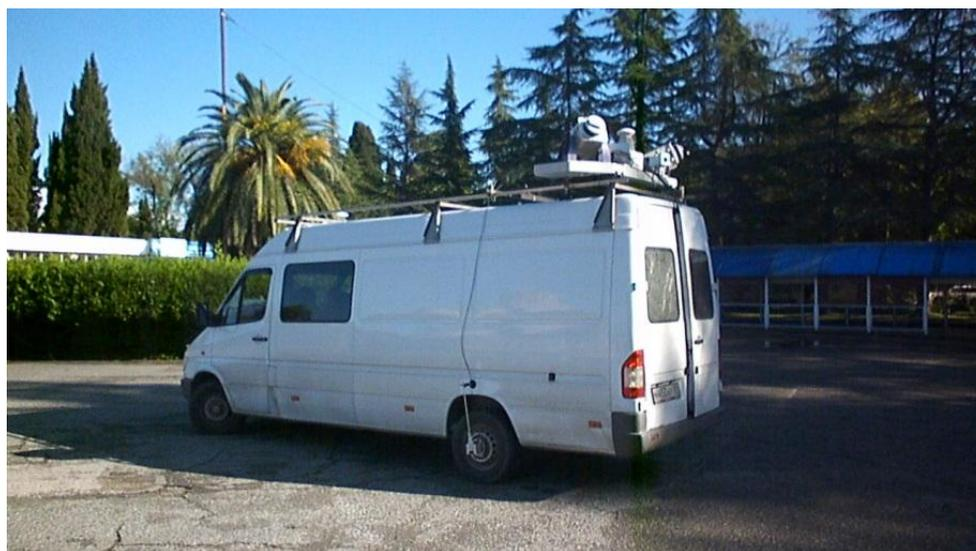
Рис. 2. Монтаж мобильной сканирующей системы LYNX на автомобиль
