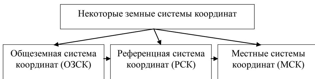
Рис. 6. Некоторые системы земных координат, используемые в геодезии
