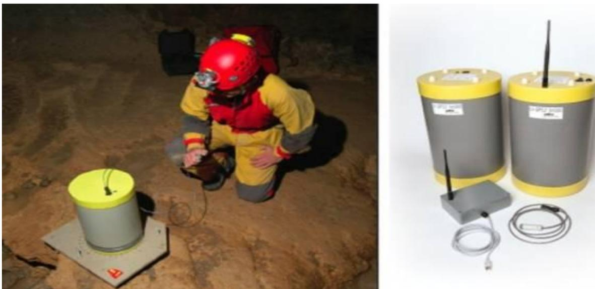
Рис. 1. Общий вид системы UGPS
