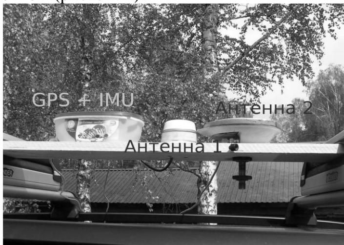
Рис. 3. Приёмник спутниковой навигации Ublox AntarisLEA-6T и инерциальный датчик Sparkfun 9DOF
