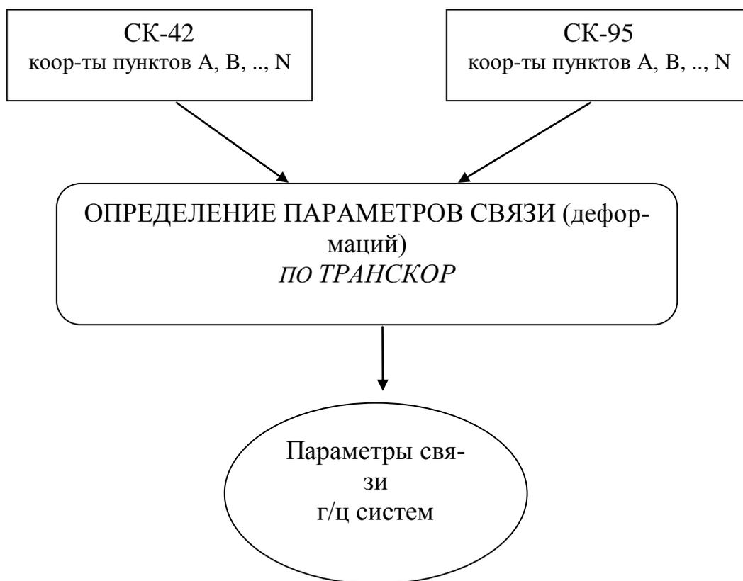
Рис. 1. Схема определения параметров связи систем координат СК-42 и СК-95
