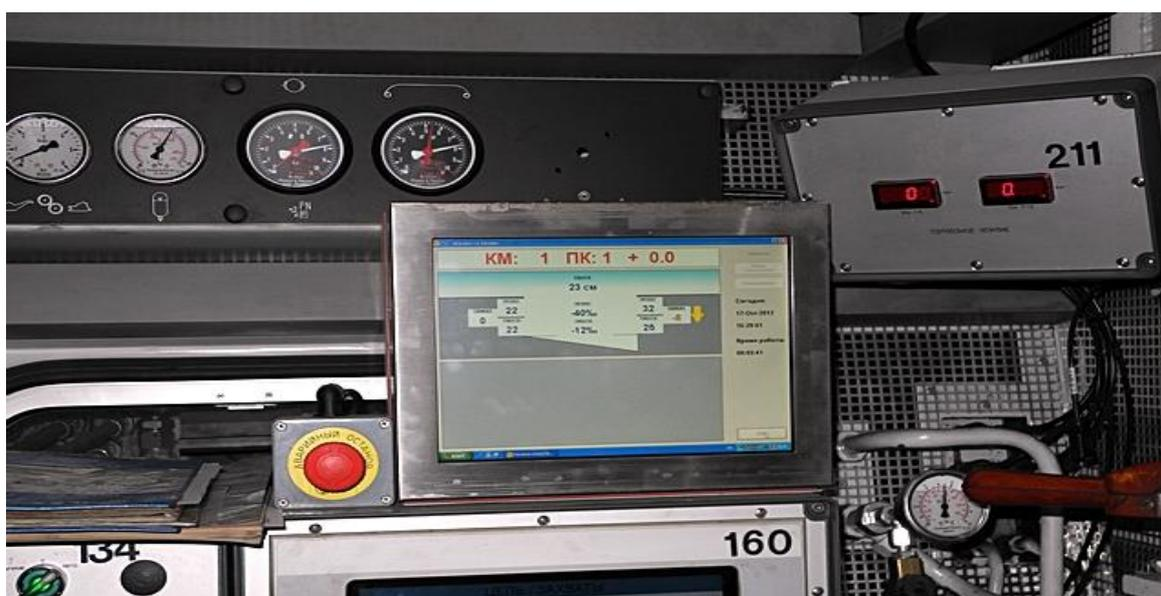
Рис. 6. САУ ЩОМ на базе ГНСС
