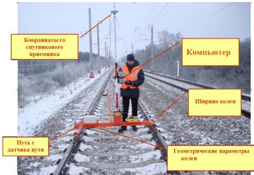
Рис. 2. АПК «Профиль»
