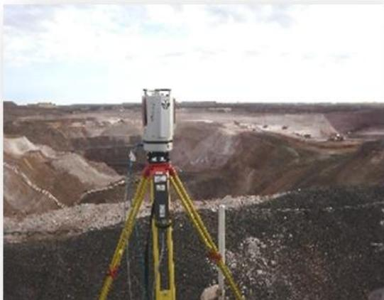
Рис. 3. Сканирующая система Riegl VZ-1000
