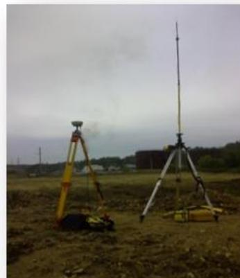
Рис. 4. GPS оборудование-RTK режиме
