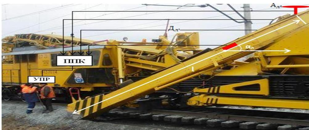
Рис. 5. Внешний вид щебнеочистительной машины, оборудованной САУ
