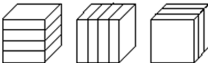
Рис. 2. Одномерная декомпозиция расчётной области
