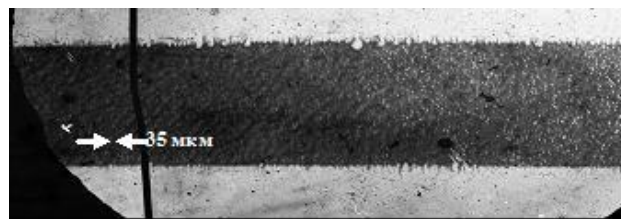
Рис. 6. Типичные рентгенограммы взорванных фольг ( t = 767 нс).
