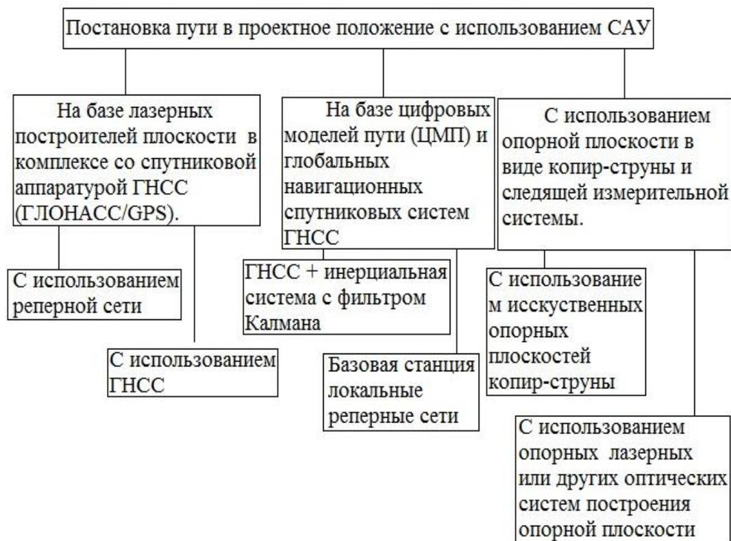
Рис. 2. Способы постановки пути в проектное положение
