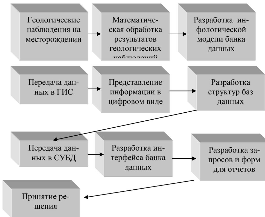
Рис. 1. Технологическая схема создания банка данных для подсчета запасов полезных ископаемых
