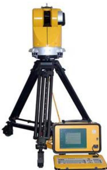
Рис. 1. Лазерный 3D сканер Callidus CP3200
