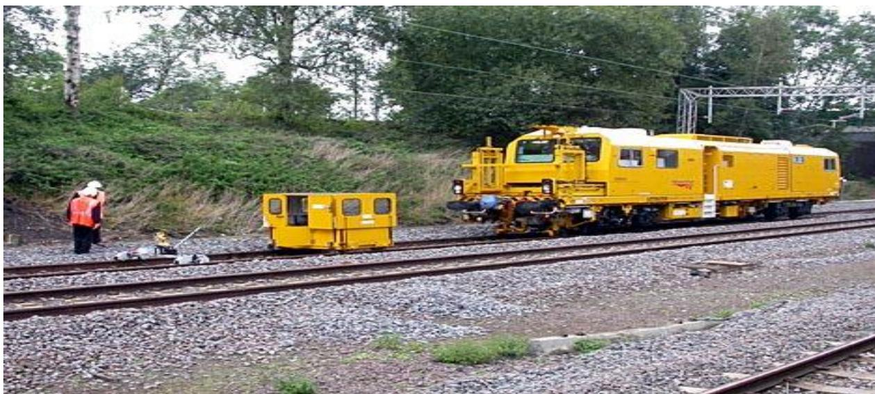
Рис. 3. Выправка пути в Италии системой EM-SAT
