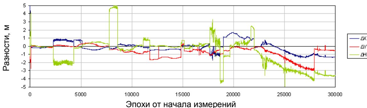
Рис. 5. Разности координат полученных точек треков для решений относительным методом и PPP (фрагмент)
