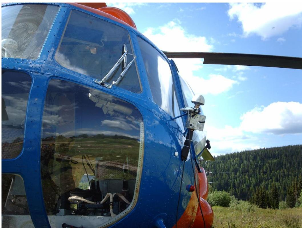
Рис. 1. Установка антенны ГНСС приёмника на зеркале заднего вида кабины вертолётa
