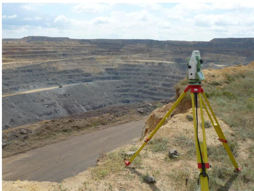
Рис. 2. Применение TMS для автоматизации разбивочных работ
