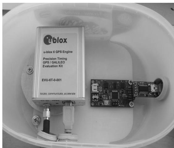
Рис. 2. Комплекс GPS+IMU, размещённый на крыше автомобиля
