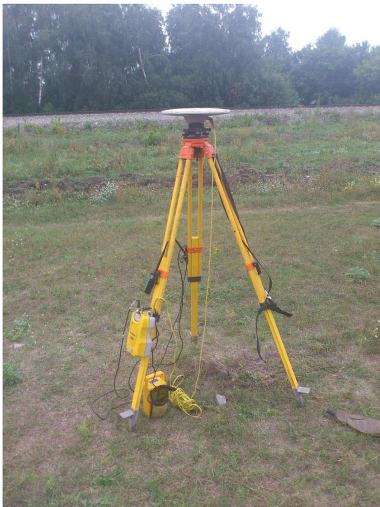
Рис. 1. Базовая станция
