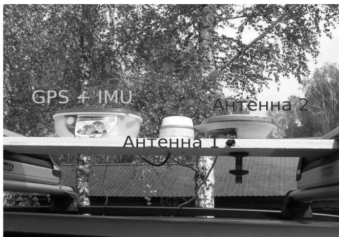
Рис. 1. Приёмник спутниковой навигации Ublox AntarisLEA-6T и инерциальный датчик Sparkfun 9DOF
