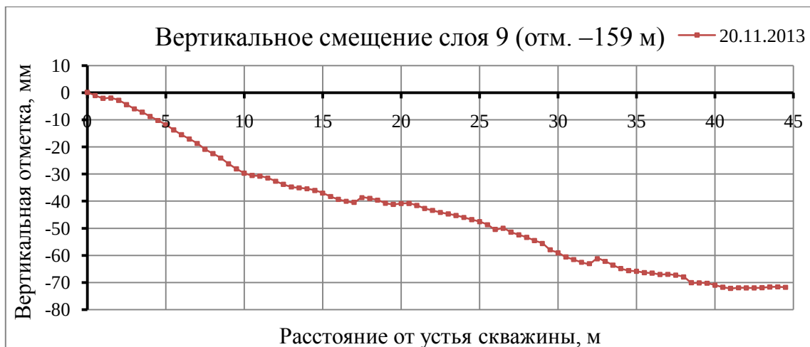
Рис. 2. Результаты инклинометрических наблюдений:
