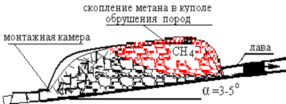
Рис. 2. Примыкание скопления метана к очистному забою из-за разности в высотных отметках по длине выемочного столба
