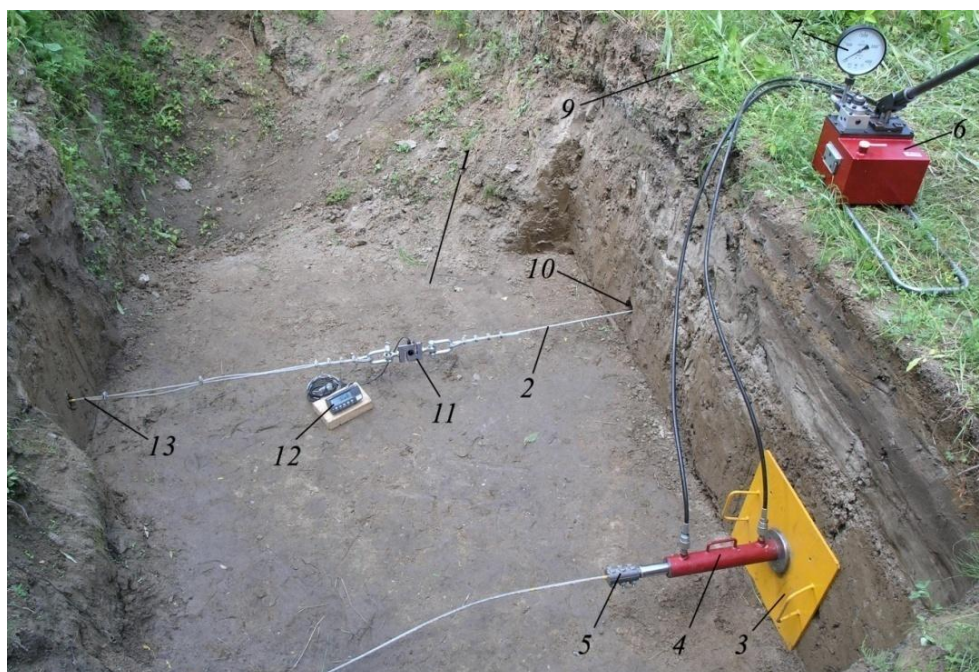
Рис. 2. Схема (а) и фотография (б) нагружения U-образного троса: 1 – котлован; 2 – трос; 3 – опорная плита; 4 – домкрат; 5 – зажим троса; 6 – насос; 7 – манометр; 8 – траншея; 9 – целик; 10, 10' – скважины; 11 – динамометр; 12 – цифровой индикатор; 13, 14 – соответственно, тяга и пята «мертвого» анкера
