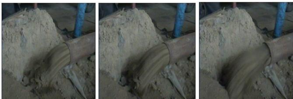
Рис. 2. Начальная, средняя и конечная стадии выхода грунтового поршня из полости вращающегося трубопровода
