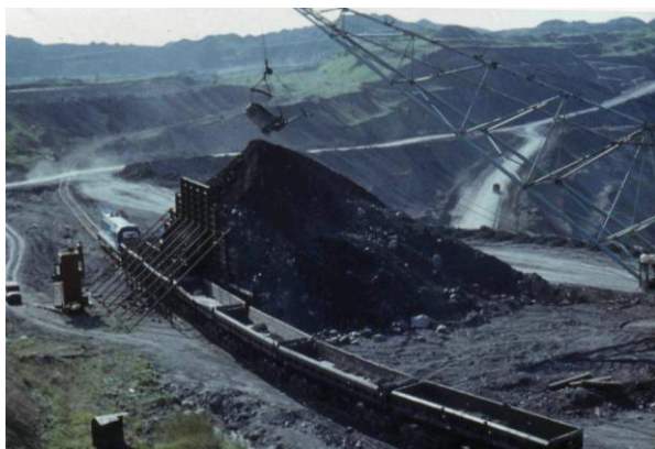
Рис. 2. Бункерно–экскаваторный перегрузочный пункт
