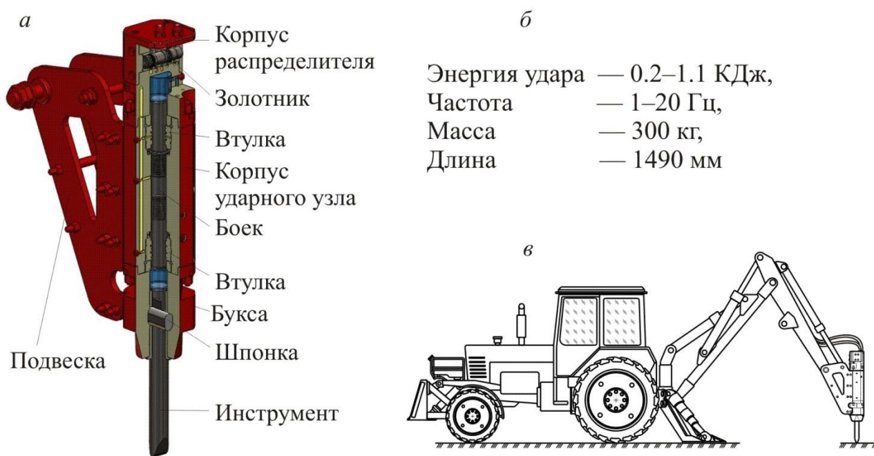
Рис. 3. 3D-модель гидромолота (а), его характеристики (б) и навеска (в) на экскаватор 2-й размерной группы на базе трактора Беларусь
