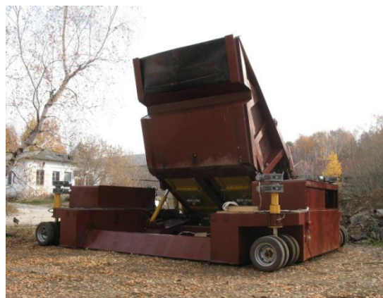
Рис. 4. Общий вид экспериментального вибрационного отвалообразователя
