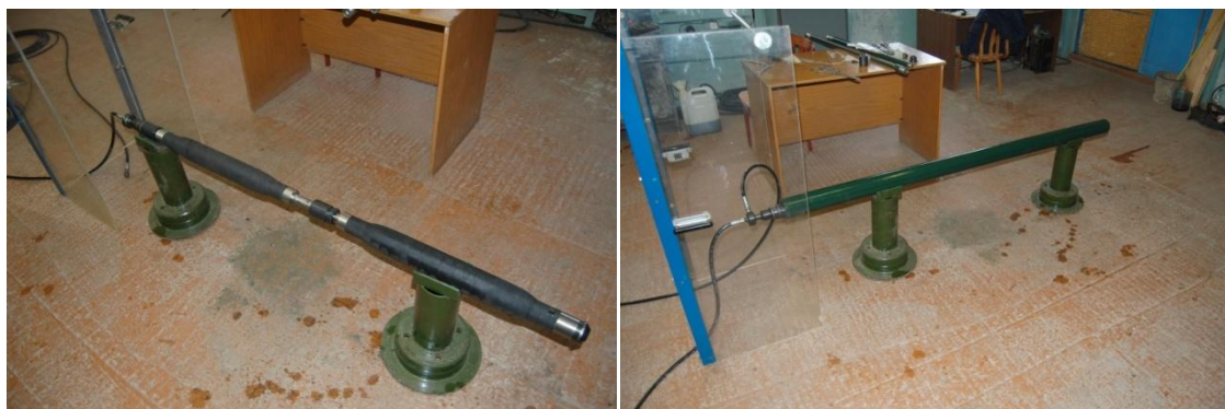
Рис. 2. Устройство разрыва в ходе стендовых испытаний.
