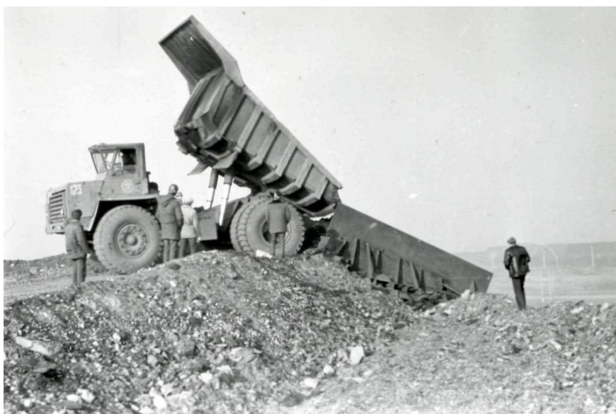
Рис. 1. Фрагмент промышленных испытаний вибрационного отвалообразователя
