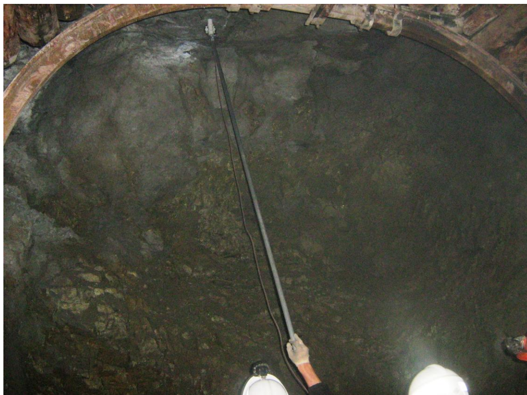
Рис. 3. Порядок РРО забоя сEDXRF спектрометром РПП – 12
