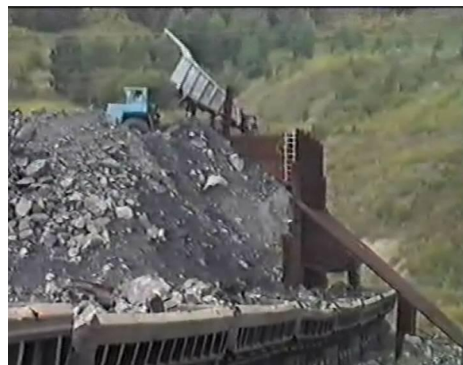
Рис. 3. Перегрузка горной массы из автомобильного в железнодорожный транспорт
