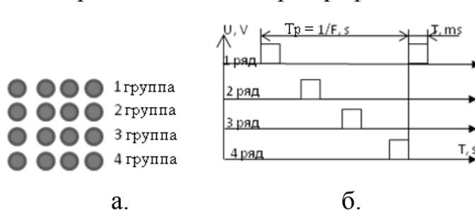
Рис. 4. а - группировка матрицы жидкостных клапанов режима В; б - диаграмма работы
