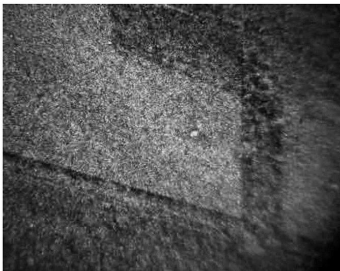
Рис. 2. Область поверхности подложки с наночастицами карбида кремния, имеющими размеры 50 – 80 нм. Свечение возникает при рассеянии излучения подсветки, падающего изнутри подложки на поверхность под углом больше полного отражения, на наночастицах поверхности
