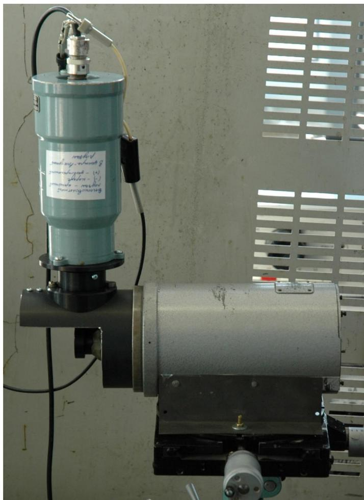
Рис. 3. Фотография оптической головки измерения динамических параметров оптического ограничителя
