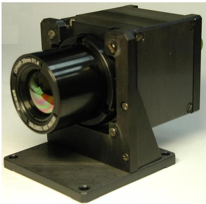
Рис. Внешний вид тепловизионного модуля на испытательном кронштейне с установленным атермализованным объективом с углом поля зрения  $15 \times 20^\circ$
