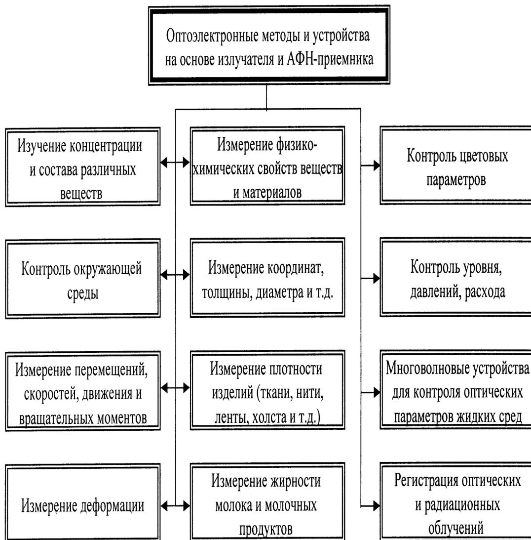
Рис. 2. Систематизированная схема возможности применения АПОИ в области разработки оптоэлектронных информационно-измерительных системах
