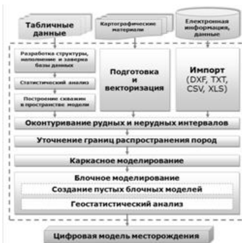
Рис. 1. Схема формирования цифровых моделей месторождений с использованием ГИС Micromine
