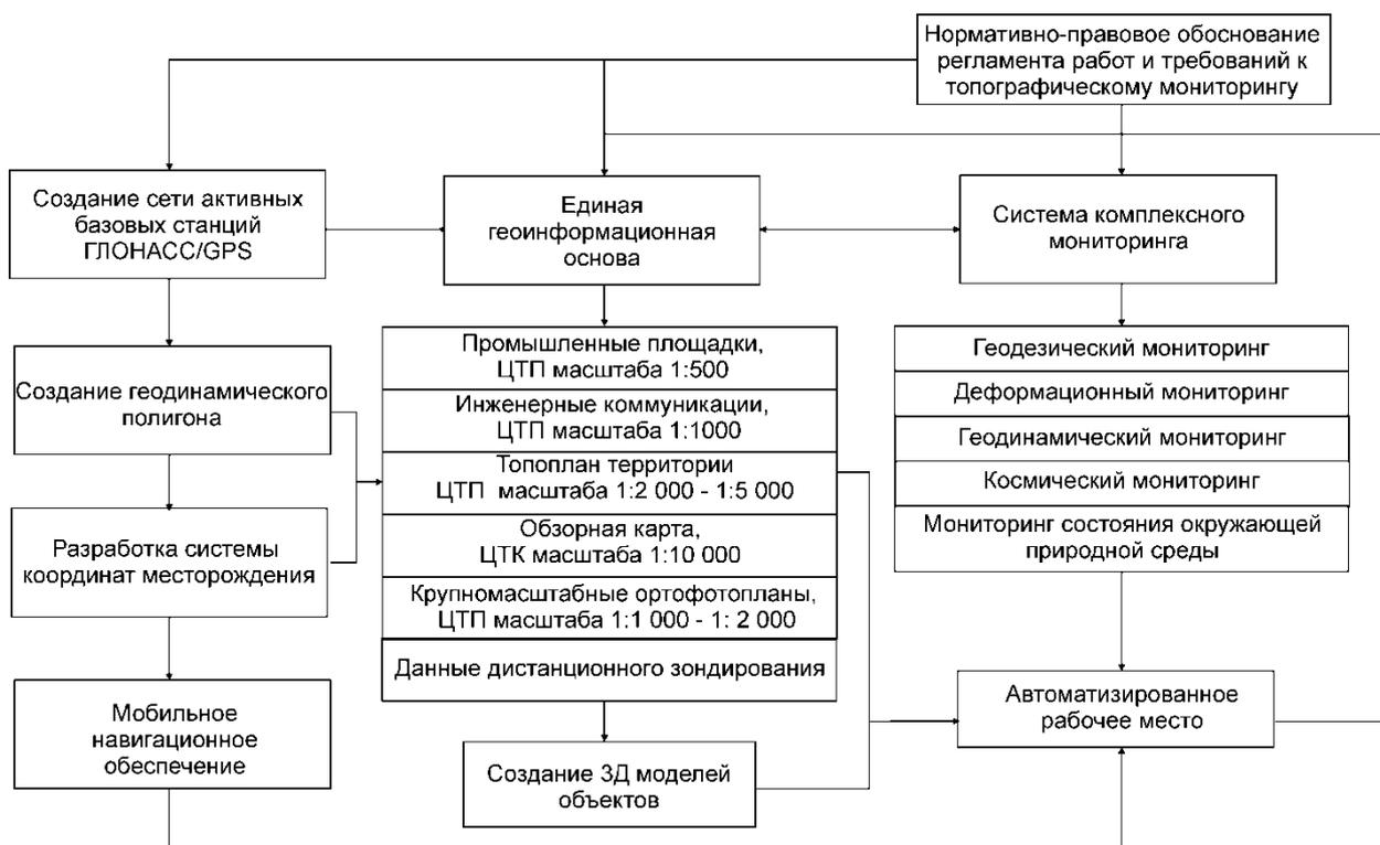
Рис. 2. Схема организации системы топографического мониторинга территории нефтегазового месторождения
