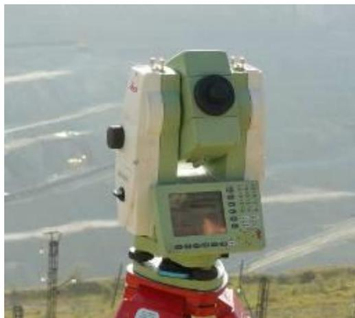
Рис. 2. Наблюдения с использованием роботизированного электронного тахеометра TCA1201
