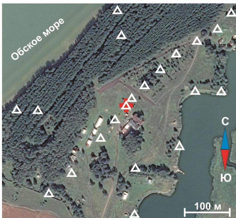
Рис. 1. Система наблюдений: крестом показано положение вибратора, треугольниками – пунктов наблюдения
