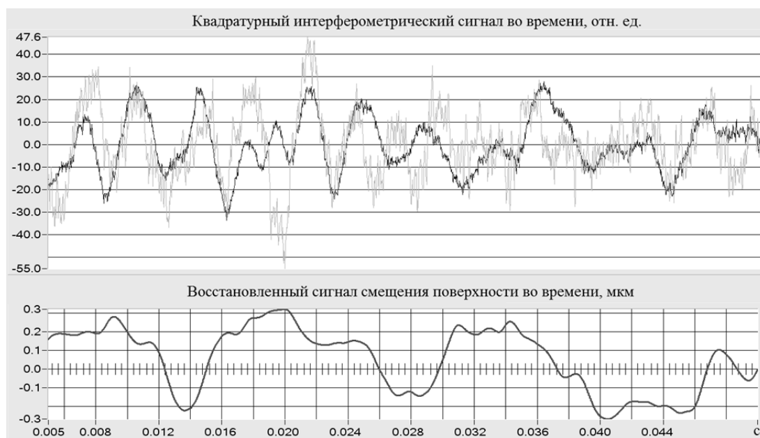
Рис. 4. Восстановленный сигнал смещения поверхности в режиме отсутствия сигнала генератора низкой частоты
