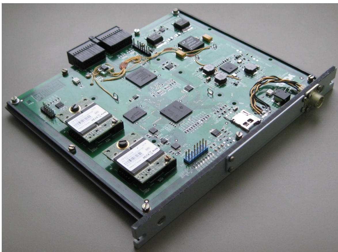
Рис. 2. Внешний вид опытного образца регистрирующего устройства для захвата и хранения тепловизионных данных
