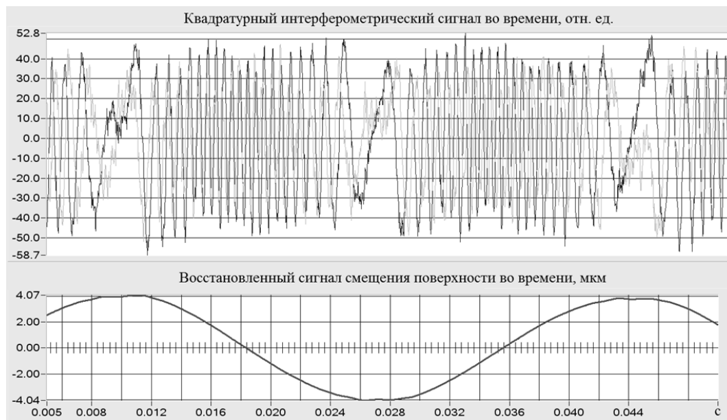
Рис. 3. Восстановленный сигнал смещения поверхности, вибрирующей на частоте 30 Гц
