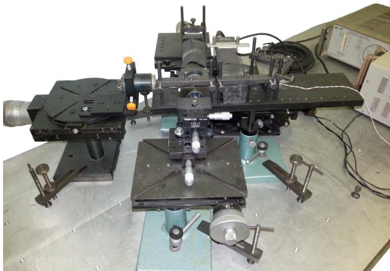
Рис. 2. Макет интерферометра с двумя каналами синхронной регистрации
