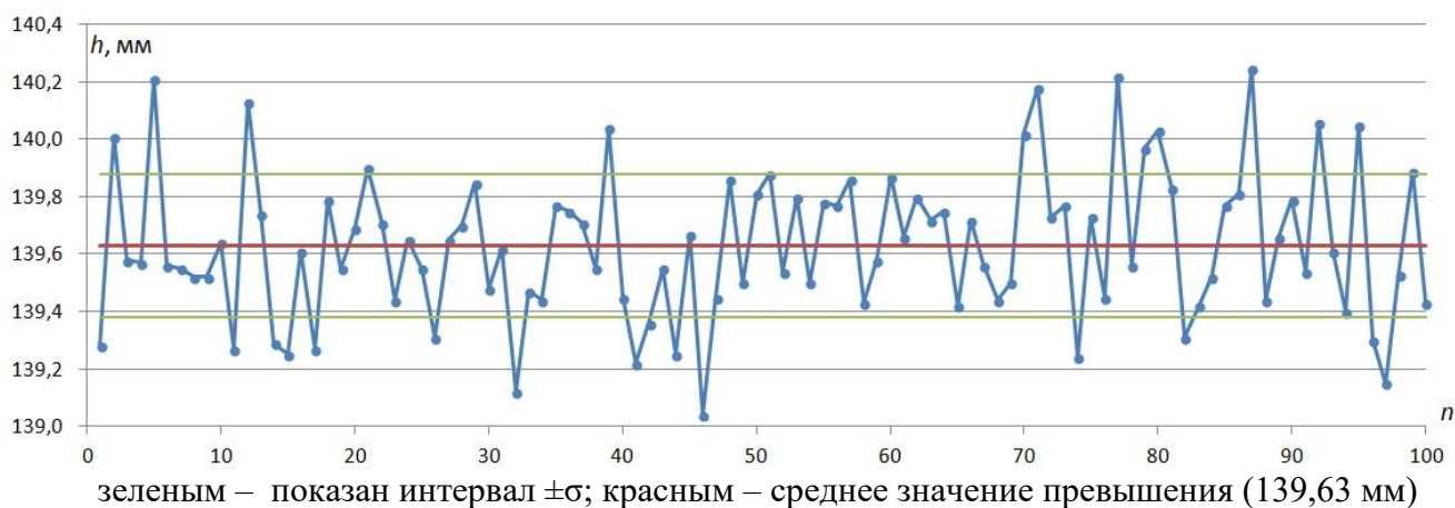
Рис. 2. График изменения значений превышения для S=56,9 м
