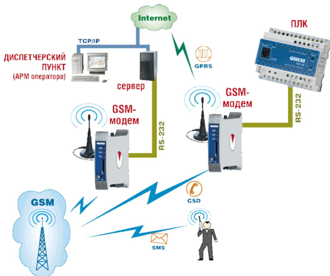
Рис. 3. Структурная схема мониторинга технологических процессов
