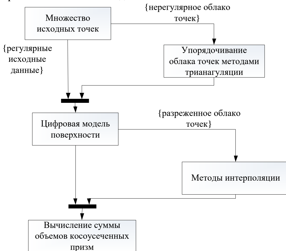
Рис. Общий алгоритм расчета объема зерна
