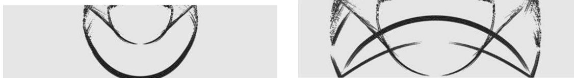
Рис. 4. Снимки двумерного волнового поля полученного при расчете конечно-разностным методом для скоростной модели эксперимента PASSCAL в моменты времени 5 с (слева) и 10 с (справа)
