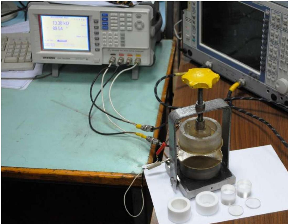
Рис. 2. Измерительная система LCR GW Instek, ZVRE Rohde&Schwarz, емкостная ячейка, фторопластовые кольца
