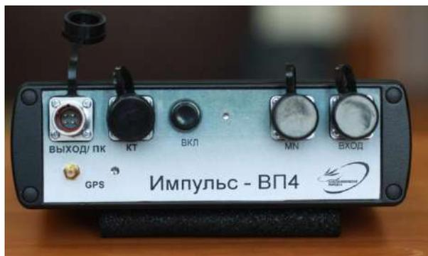
Рис. 1. Четырехканальный измерительный модуль «Импульс ВП4»
