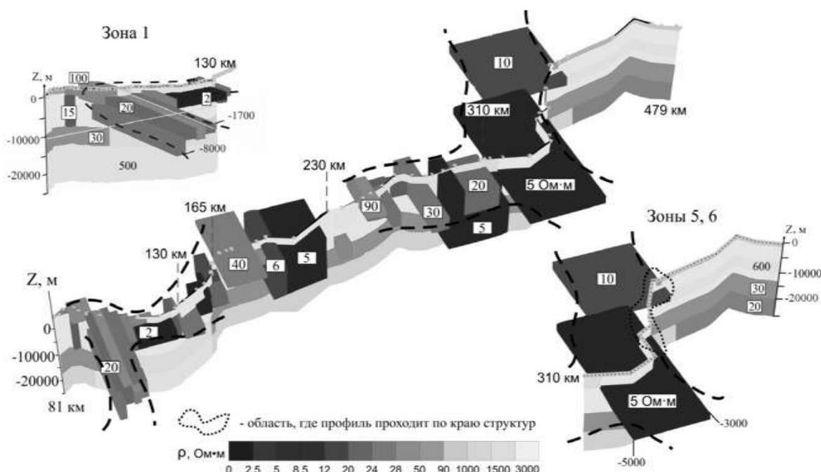
Рис. 5. Геоэлектрический разрез вдоль регионального профиля в объеме и проводящие объекты 3D-модели, полученные по результатам 3D-интерпретации
