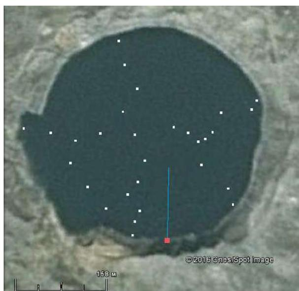
Рис. 1. «Атомное» озеро. Отмечены пункты термокаротажа водной толщи в июле, октябре 2013 г. и в июне 2014 г. (точки) и станция мониторинга температуры придонной воды (красная точка – расположение измерителя, синяя линия – расположение термокосы)
