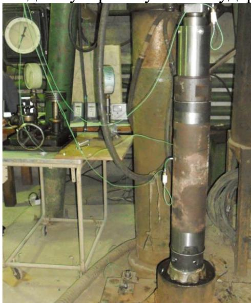
Рис. 3. Исследование пневмоударника П165 на вертикальном стенде ГД251
