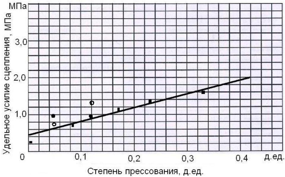
Рис. 2. Зависимость максимального удельного сцепления анкера со стенками шпура от степени прессования древесины
