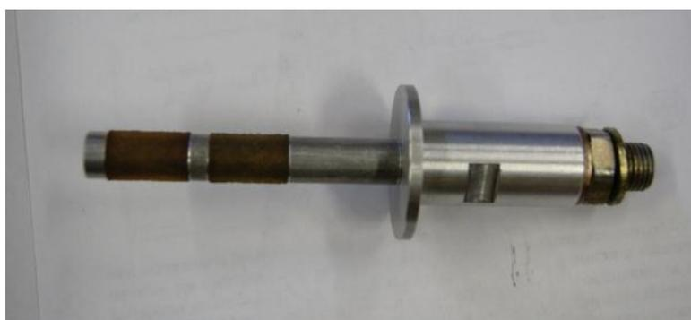
Рис. 2. Макет скважинного зонда
