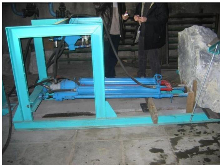
Рис 1. Станок СБП с пневмоударником АШ-46А на стенде
