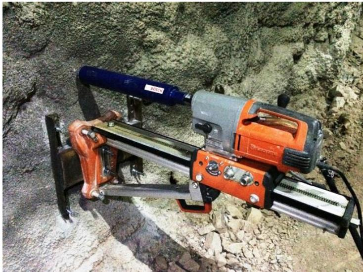
Рис. 2. Буровая установка с буровым стандом Husqvarna, коронка Bosch
