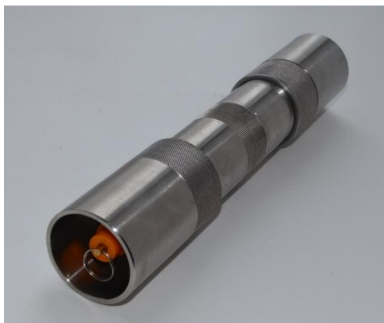
Рис. 3. Контейнер для транспортировки керна.
