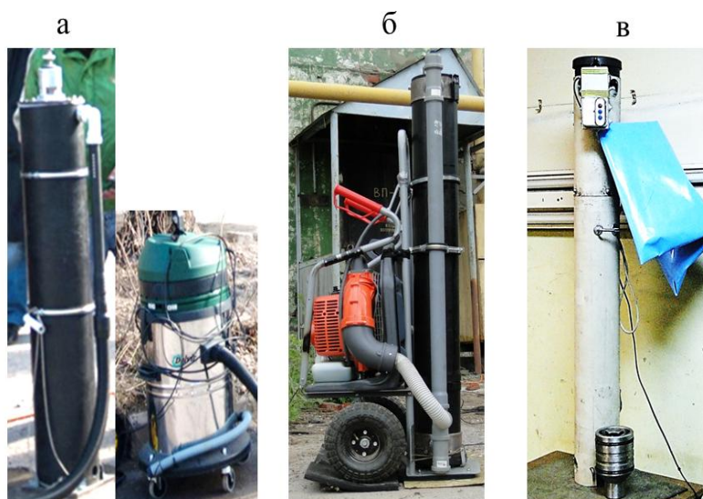
Рис. Компрессионно-вакуумные ударные машины: а – КВУМ-1; б – КВУМ-2; в – КВУМ-3
