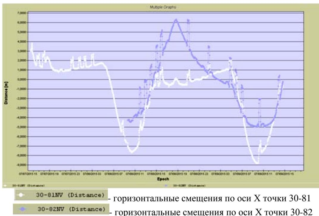
Рис. 9. Горизонтальные смещения по данным измерений инклинометров
