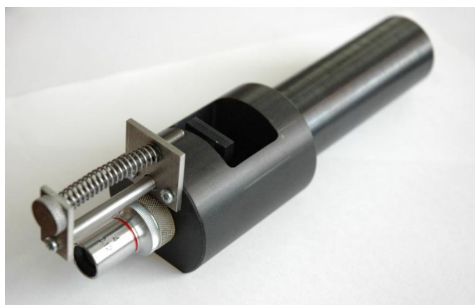
Рис. 3. Фотография оптической приставки Z – сканирования
