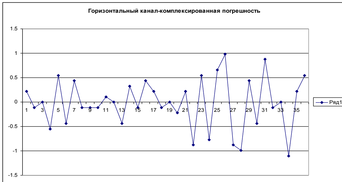
Рис. 3. Погрешность измерения малых углов датчиком при пошаговом изменении угла на 10"
