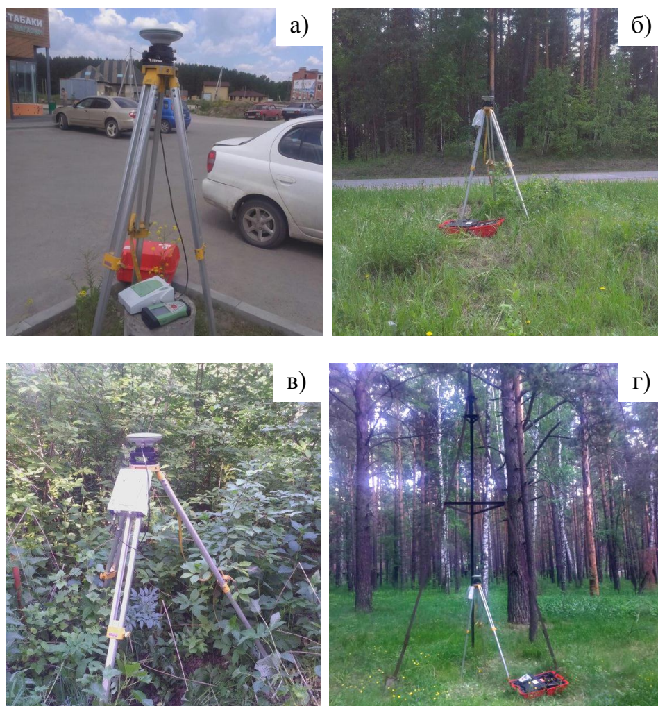
Рис. 2. Расположение мобильной станции на пунктах эталонного геодезического полигона
