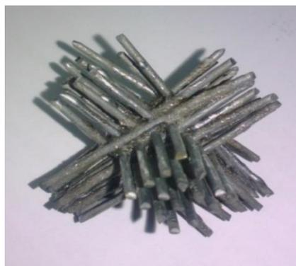
Рис. 2. Извлеченный каркас из стальной проволоки
