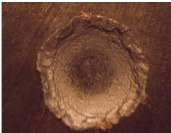
Рис. 6. Кратер, образовавшийся при попадании пули «ДЭРИ» в стальную плиту при стрельбе в упор из ВПО-208 патроном с разделенным пороховым зарядом
