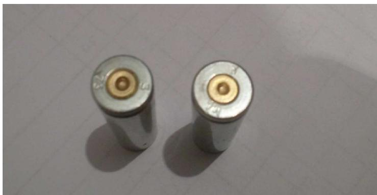
Рис. 5. Слева гильза от штатного патрона после выстрела, справа гильза от модернизированного патрона после выстрела
