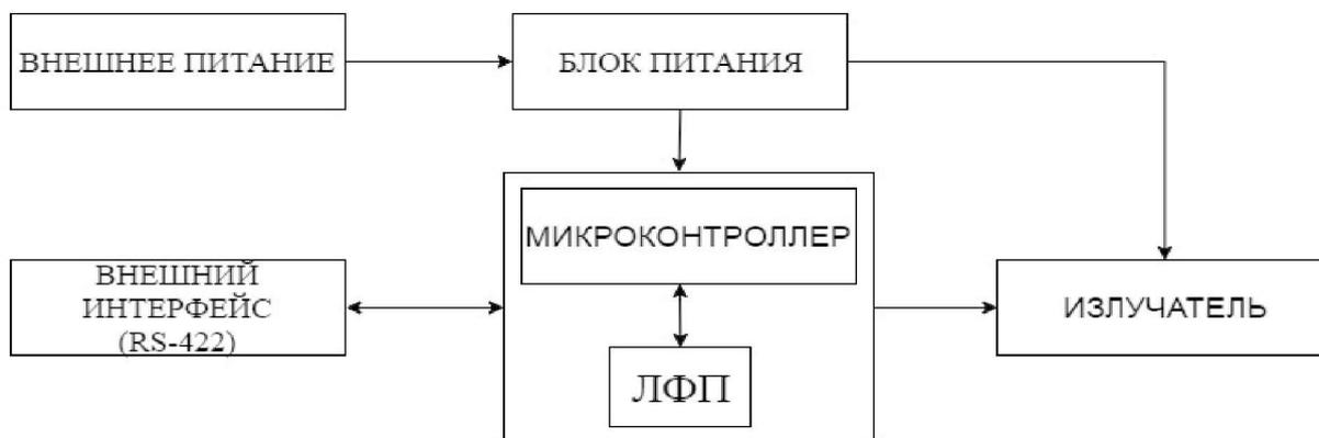
Рис. 3. Структурная схема лазерного триангуляционного дальномера
