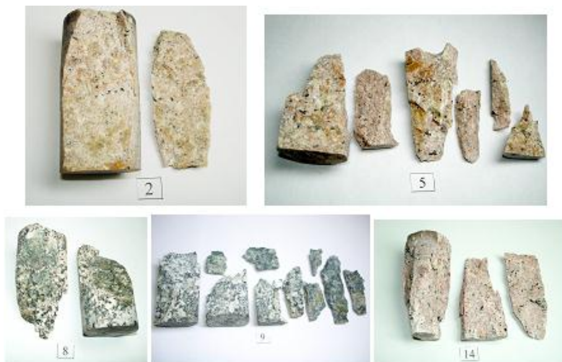
Рис. 1. Фотографии образцов керна гранита после разрушения:
