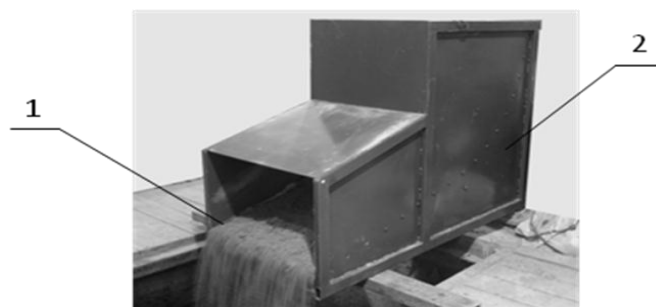
Рис. 4. Экспериментальный образец вибропитателя для выпуска сыпучих материалов, в том числе связных:
