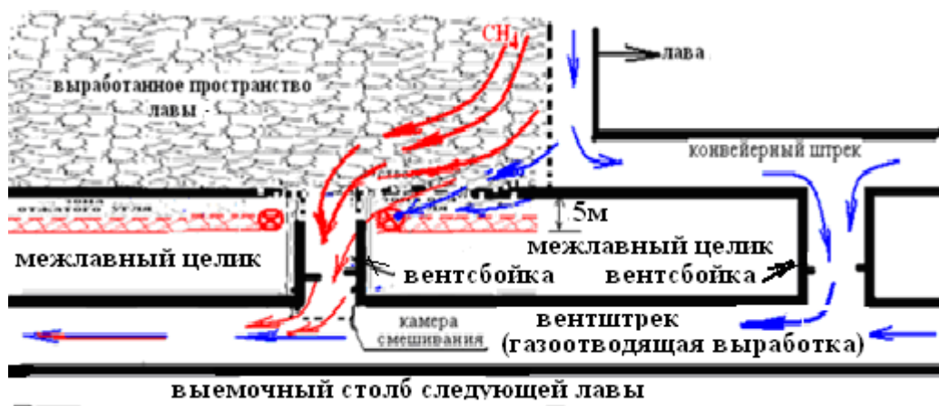
Рис. 3. Очаги самонагрева угля, возникающие в краевой части межлавного целика на сопряжении вентсбойки с выработанным пространством действующей лавы, где:
