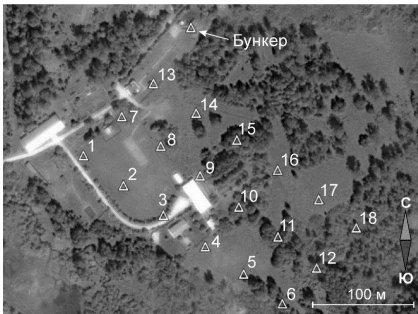
Рис. 1. Схема системы наблюдений на территории обсерватории; треугольниками показаны места установки сейсмоприемников
