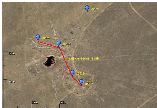
Рис. 1. Схема расположения исследовательских скважин возле «боевой» скважины № 104 на площадке «Сары-Узень»
