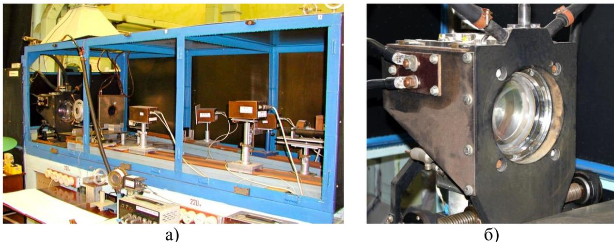
Рис. 8. Общий вид стенда излучателя (а) и лампы ДКсРМ-55 кВт (б)
