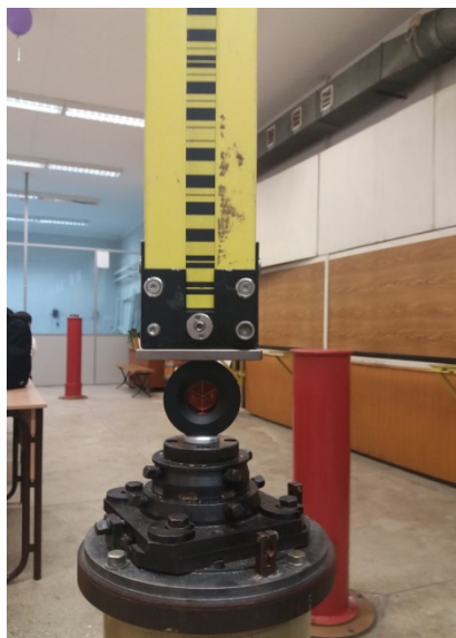
Рис. 5. Схема установки призмы и нивелирной рейки
