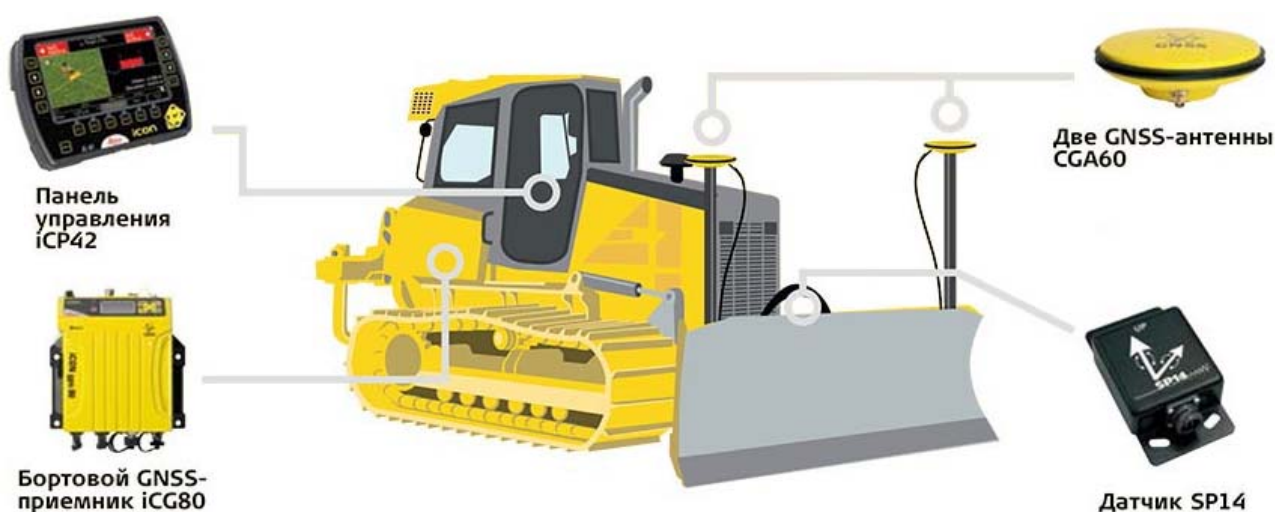
Рис. 3. CAU-3D на базе ГНСС и датчиков пространственной ориентации
