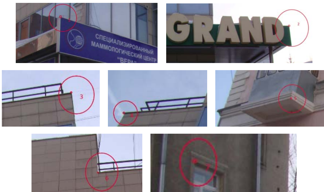
Рис. 3. Опорные точки для внешнего ориентирования плотного облака точек, полученного из фотосъемки
