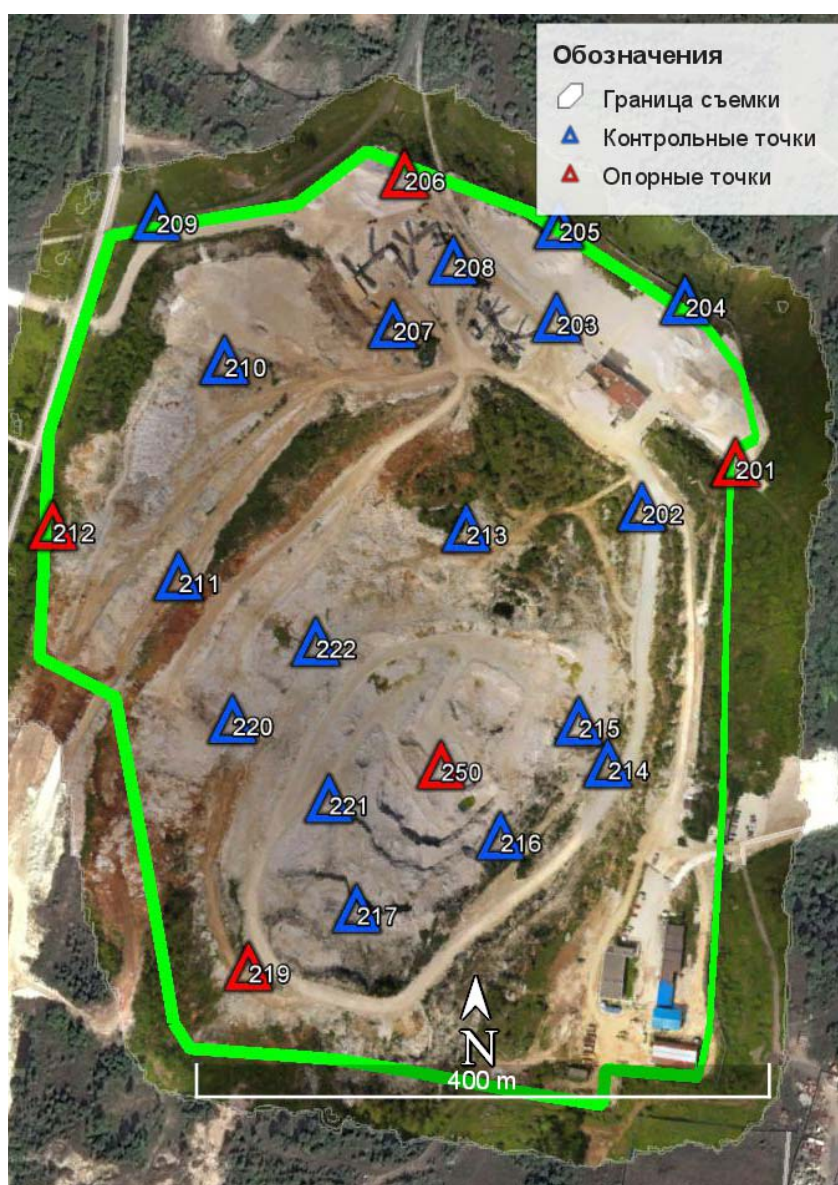
Рис. 3. Схема расположения точек ПВП для аэрофотосъемки всего карьера
