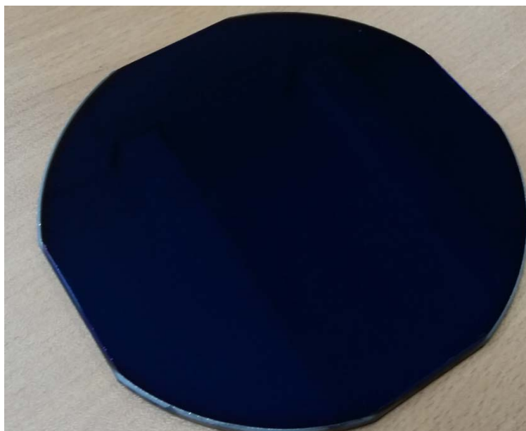
Рис. 2. Фотография нанесенного «черного» хрома на стеклянную подложку \varnothing 106 мм
