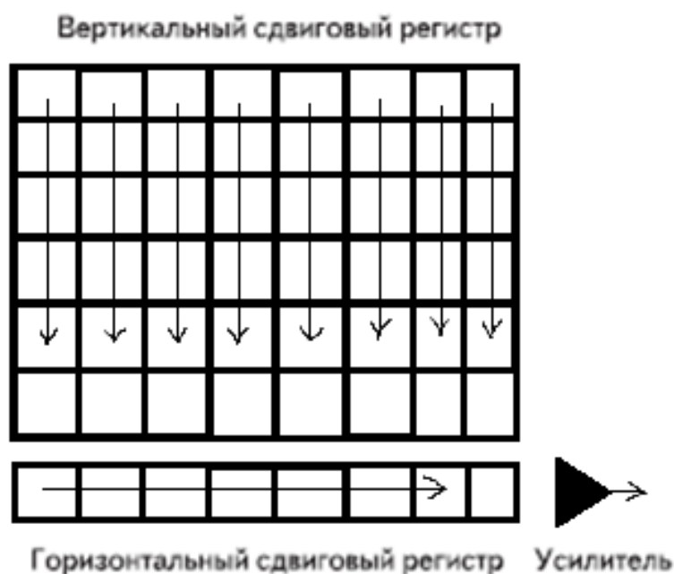
Рис. 2. Принцип считывания информации из ПЗС матрицы
