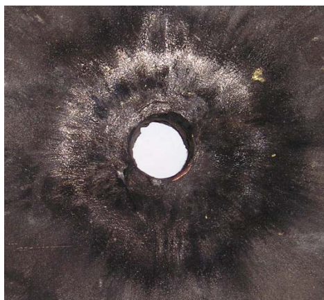
Рис. 6. Плита из алюминиевого сплава АМЦ после пробития фторопластовым ударником
