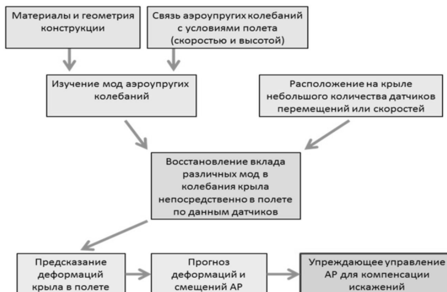
Рис. 1. Структурная схема построения системы упреждающего управления ФАР
