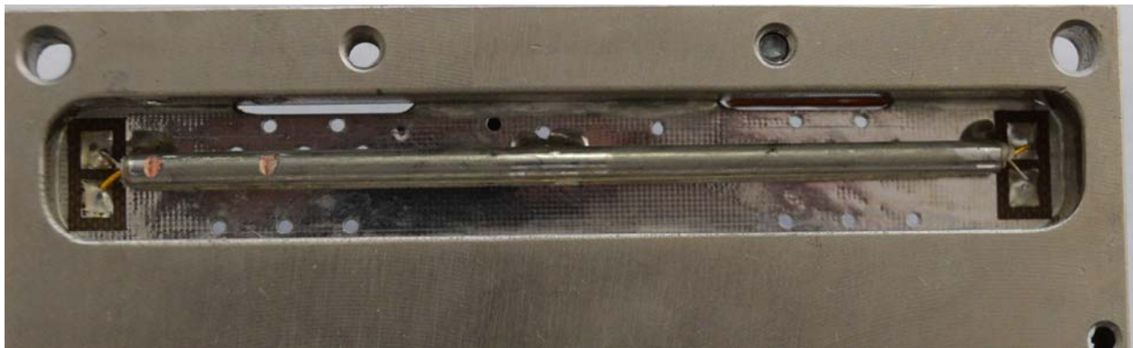
Рис. 1. Квадратурный мостовой ответвитель в виде экранированного отрезка двухпроводной линии
