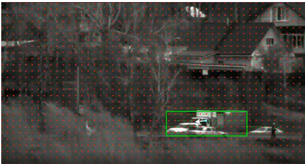
Рис. 2. Кадр изображения с быстро двигающимся объектом: точки на изображении соответствуют реперным точкам, используемым для анализа видеопотока; грузовой автомобиль выделен прямоугольником; стрелка в центре прямоугольника показывает направление и величину смещения грузовика
