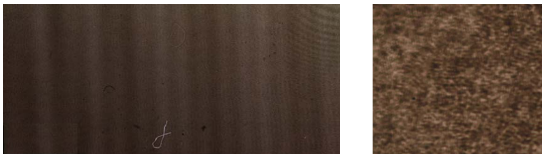
Рис. 2. Слева: оцифрованная голограмма размером 25861 \times 11690 точек. Физический размер оцифрованной голограммы – 10,8 \text{ мм} \times 5 \text{ мм} . Справа: увеличенный участок той же голограммы
