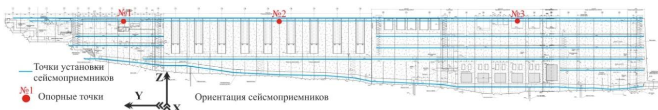
Рис. 2. Система наблюдений в бетонной плотине Богучанской ГЭС
