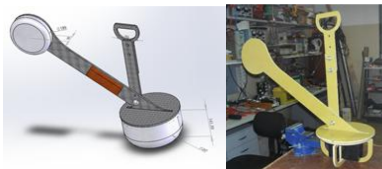
Рис. 2. Прототип № 2 аппаратуры электромагнитного профилирования: 3D-модель (слева) и изготовленный несущий каркас аппаратуры (справа)
