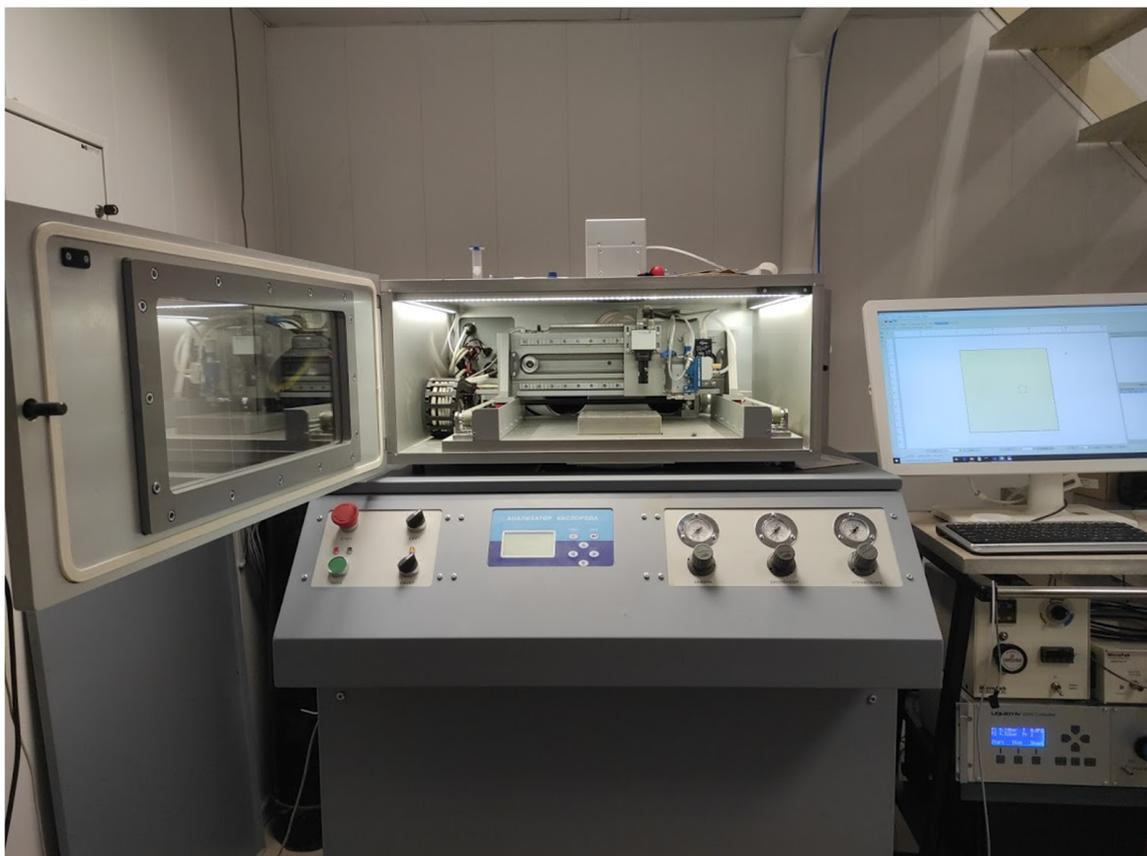
Гибридная установка для изготовления печатной электроники
