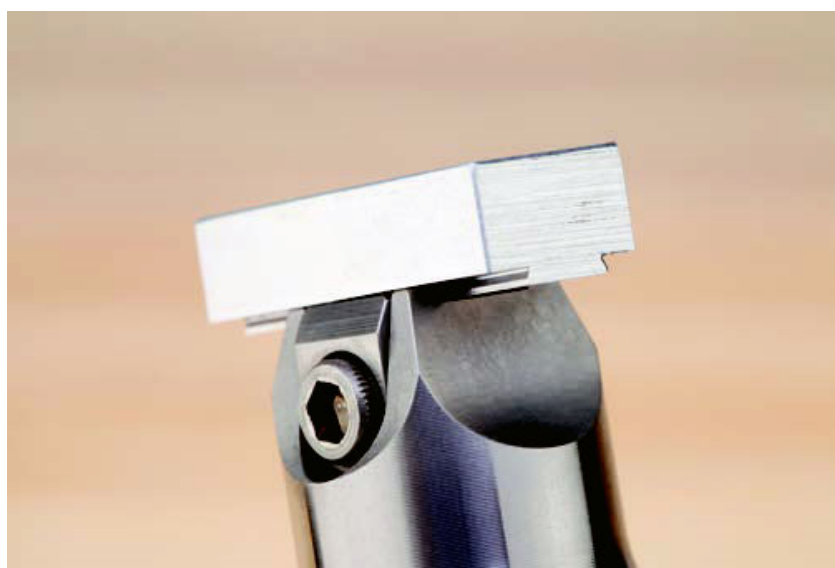
Рис. 1. Общий вид установки изделия в приспособлении типа «Раптор» по направляющим, выполненным в заготовке
