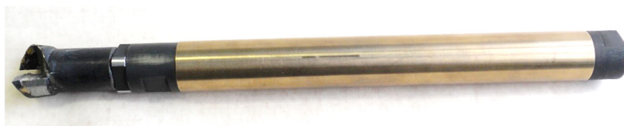
Рис. 3. Экспериментальный образец малогабаритного погружного пневмоударника АШ43
