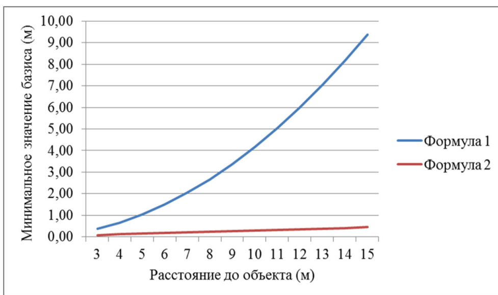
Рис. 4. Расчет минимального базиса при стереофотограмметрической съемке
