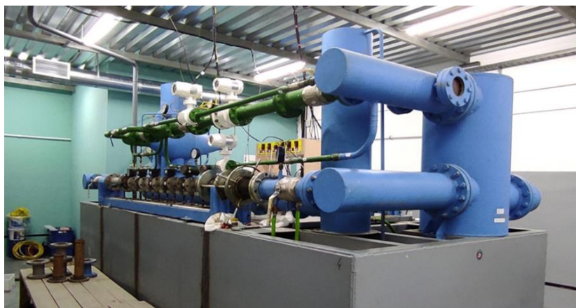
Рис. 1. Общий вид эталона единицы объема жидкости в потоке
