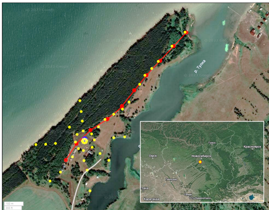
Рис. 1. Спутниковая карта Быстровского полигона с отмеченными на ней сейсмическими станциями (желтым цветом), вибрационной установкой (синим цветом) и профилей МПВ (красным цветом).
