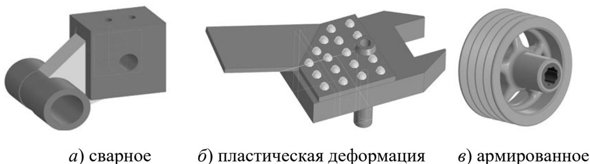
Рис. 4. Модели неразъемных соединений
