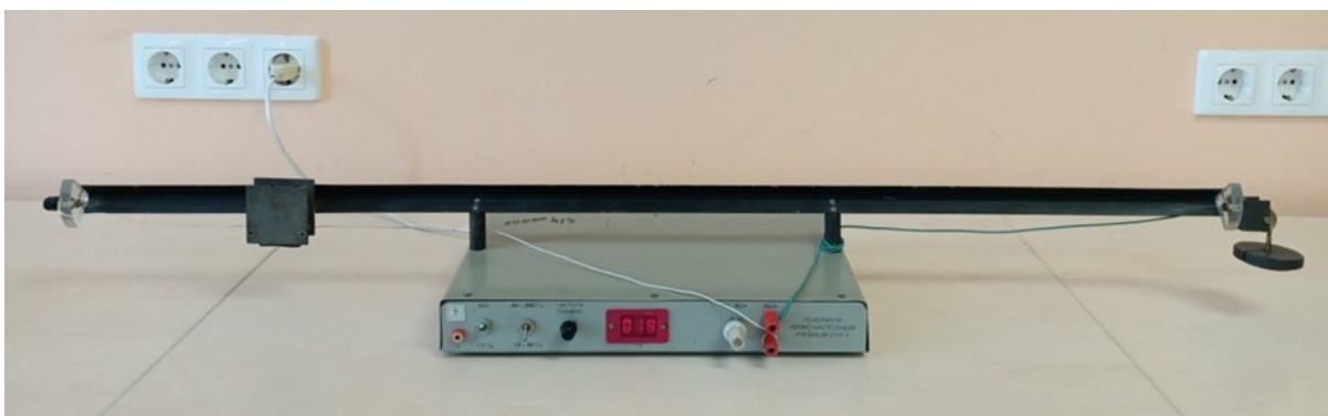
Рис. 6. Установка для демонстрации стоячей волны
