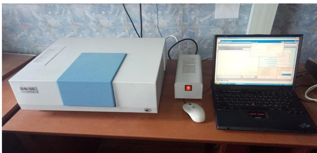
Рис. 4. Спектрофотометр СФ-56
