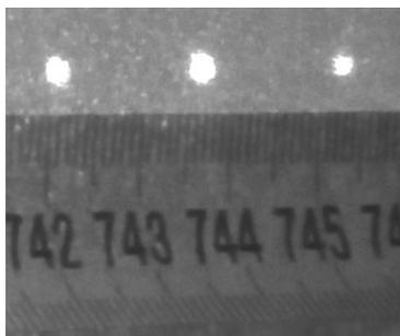
Рис. 7. Дифракционная картина излучения ИК-лазера, прошедшего сквозь дифракционную решетку
