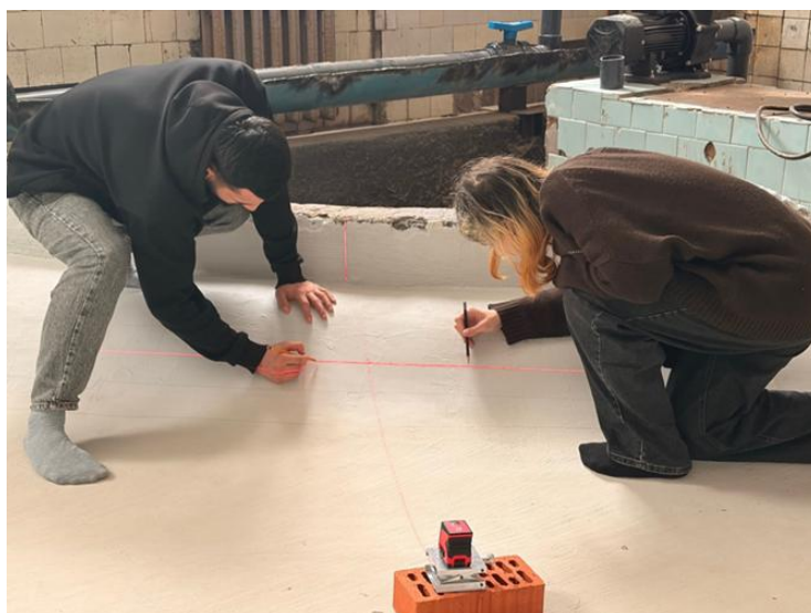
Рис. 5. Проведение горизонталей на модели русла участка реки
