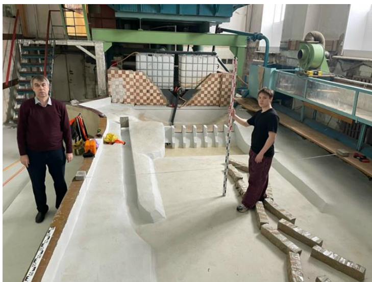
Рис. 4. Нивелирование поверхности модели русла участка реки
