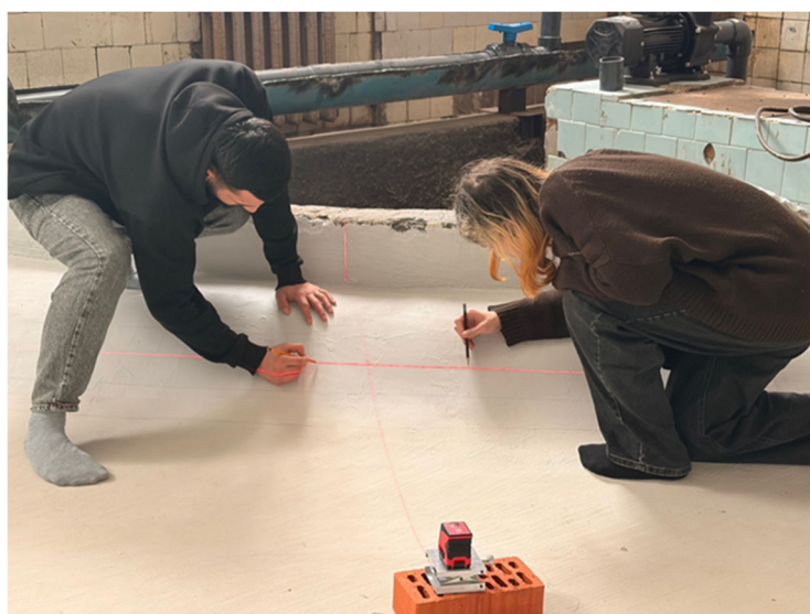
Рис. 5. Проведение горизонталей на модели русла участка реки
