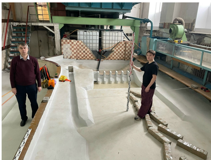
Рис. 4. Нивелирование поверхности модели русла участка реки
