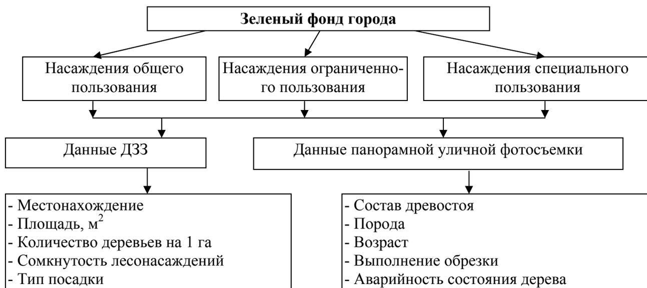
Рис. 1. Принципиальная схема комплексного использования ДЗЗ и наземной фотосъемки для инвентаризации зеленых насаждений
