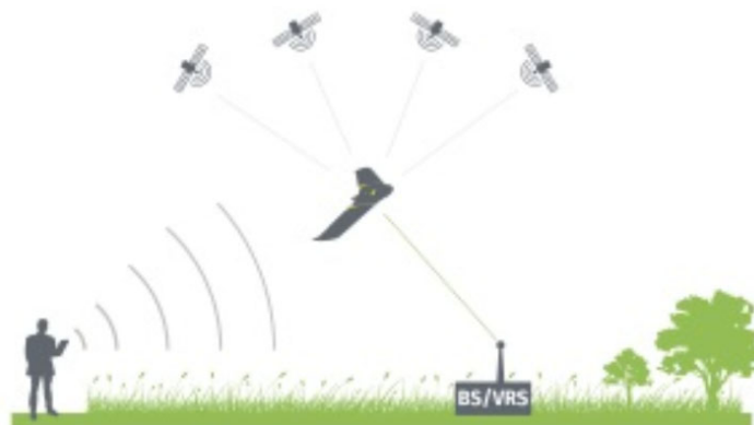
Рис. 3. Связь между спутниками GPS, БПЛА и базовой станцией
