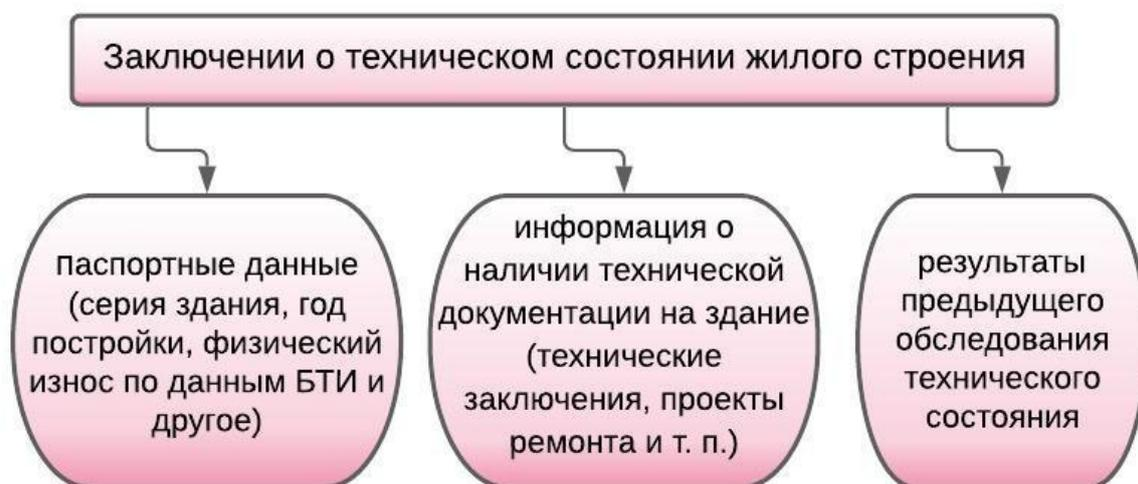
Рис. 6. Заключение о техническом состоянии
