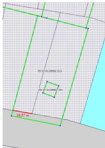
Рис. 5. Реестровая ошибка земельного участка 70:21:0120002:212
