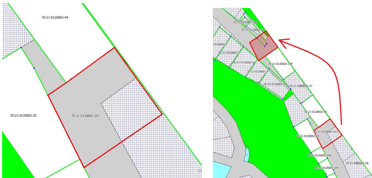
Рис. 3. Реестровая ошибка земельного участка 70:21:0120002:251
