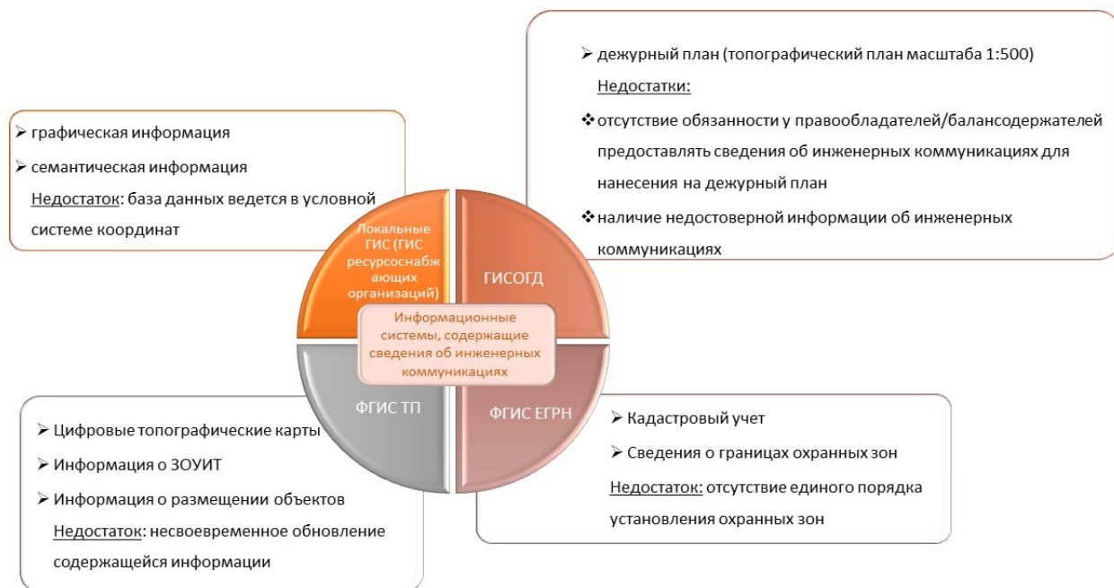
Рис. 1. Структура информационных систем, содержащих пространственные данные об инженерных коммуникациях
